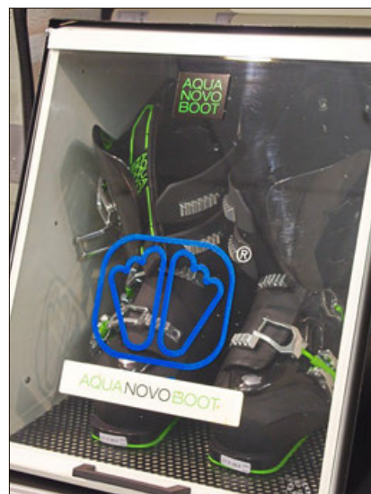
Die Außenschale wird erwärmt.
